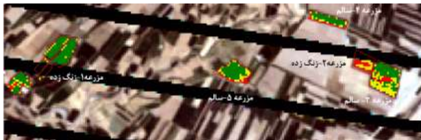
شکل (۶). تصویر حاصل از طبقه بندی با استفاده از مدل WHI در تاریخ ۱۳۹۳/۲/۱۸. رنگ های سبز، زرد و قرمز در تصویر به ترتیب نشان دهنده پیکسل های سالم، مشکوک و ناسالم می باشند.
