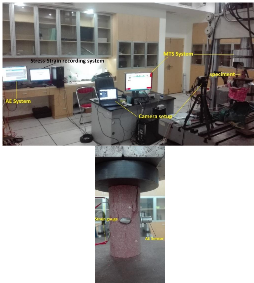
شکل ۱. تجهیزات استفاده شده در آزمون مقاومت فشار تک محوری استاتیکی
