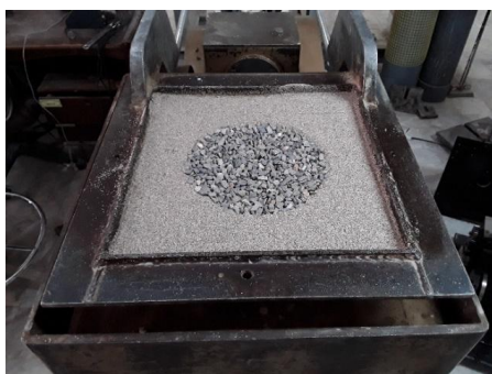
شکل ۴. آرایش قرارگیری ستون‌های سنگی منفرد الف) ۸/۴٪، ب) ۱۲٪، ج) ۱۶/۴٪، د) ۲۵٪
