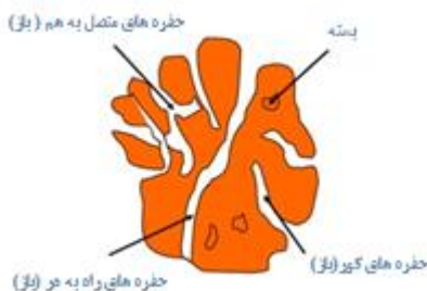
شکل ۲. نوع تخلخل‌ها بر اساس شکل و موقعیت [۲]
