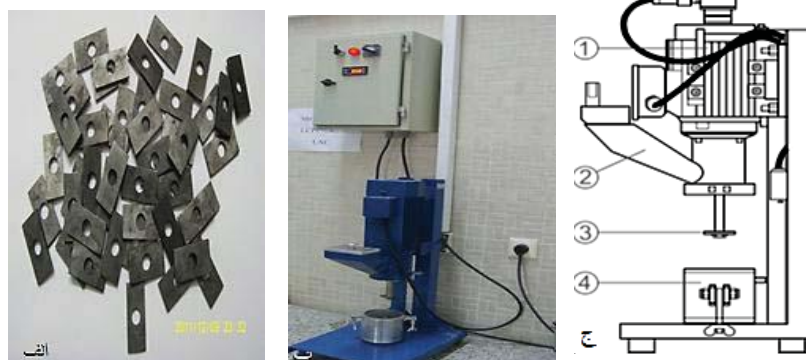
شکل ۵. مجموعه تجهیزات آزمایش LCPC با پروانه آن [۱۰]
